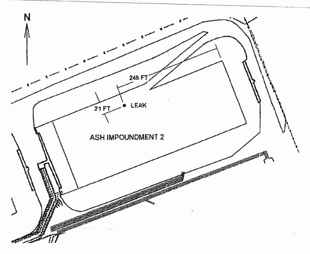
FIGURE 1. APPROXIMATE LOCATION OF THE LEAK
